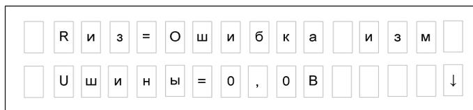
2.3.6 Реле измеряет сопротивление изоляции шин оперативного тока при условии, если общая емкость сети относительно земли не превышает 20 мкФ. При емкости сети более 20 мкФ точность измерения сопротивления изоляции не нормируется.
