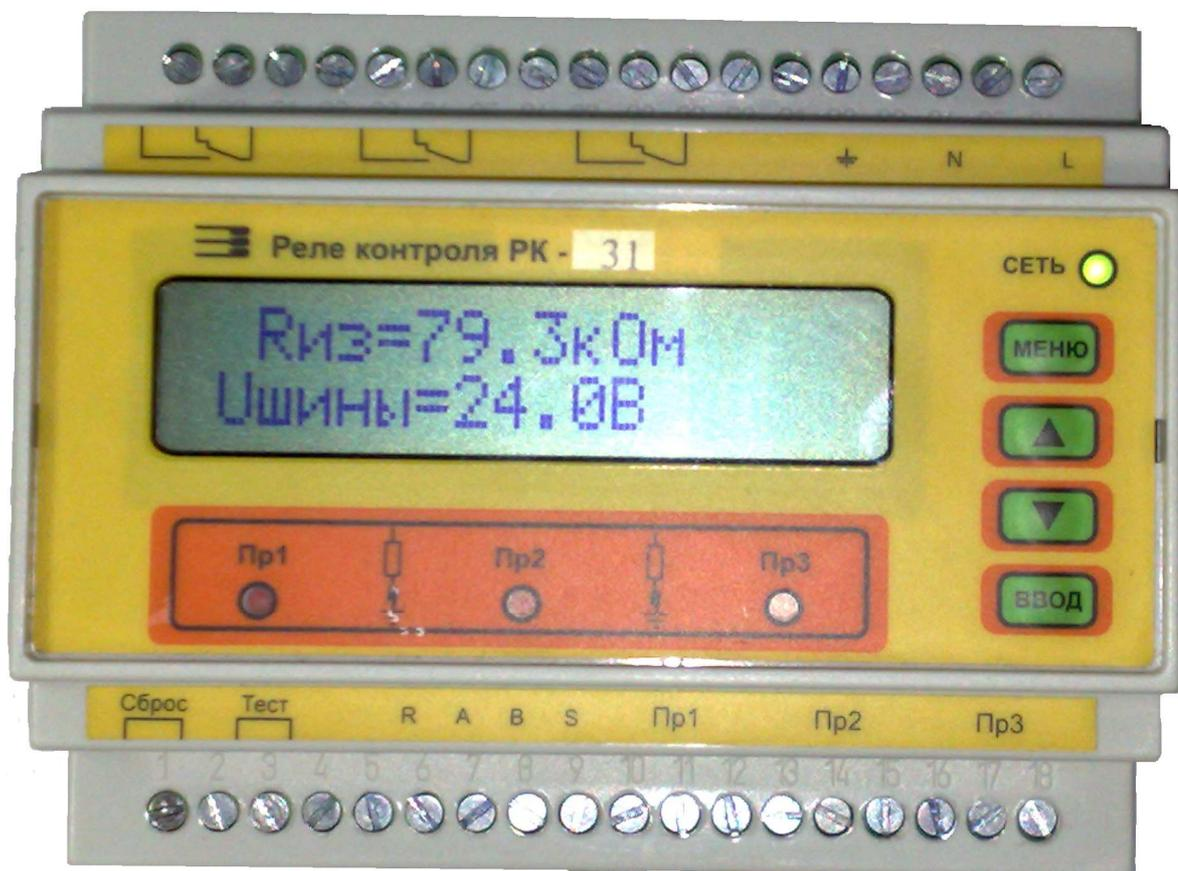
Рисунок 1 – Реле контроля изоляции цепи постоянного тока РК-31
